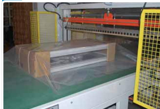
Товары в разобранном виде упаковываются установкой для упаковки автоматически
